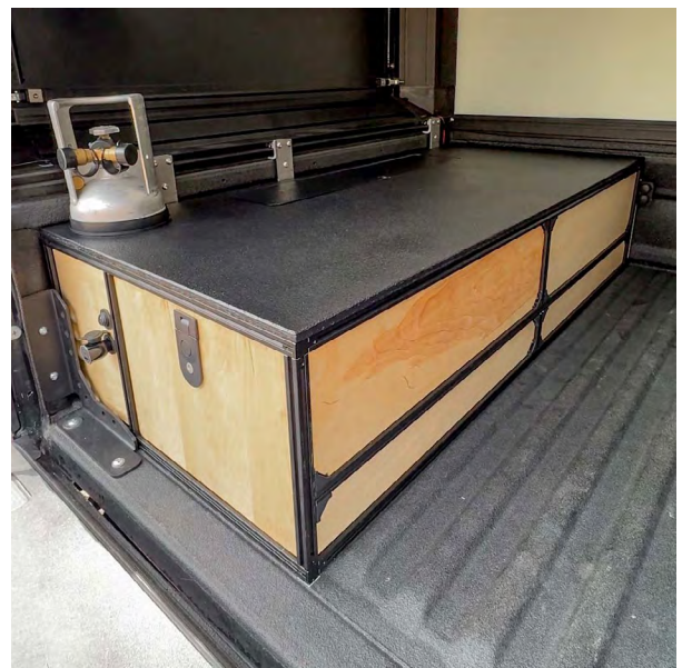
Ilustración 68 Mueble hecho de perfiles de aluminio de manera artesanal
