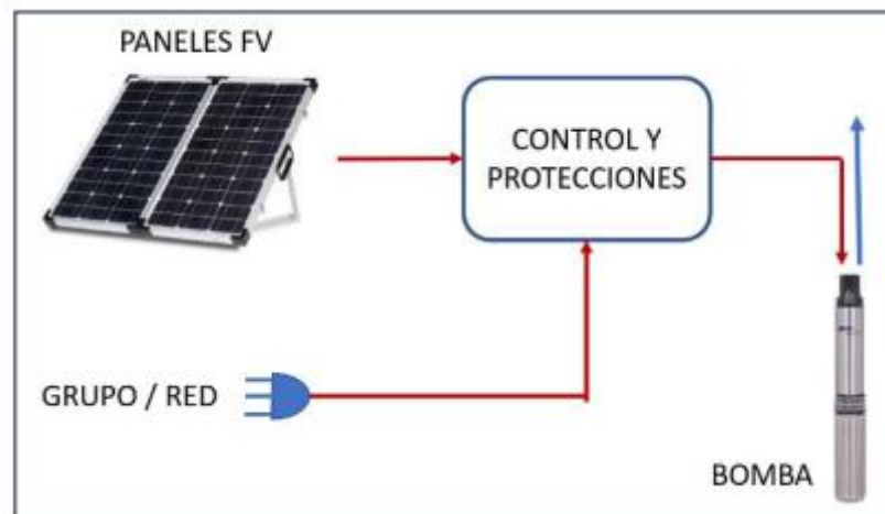
Imagen 20: Funcionamiento del bombeo solar conectado a red [18]
