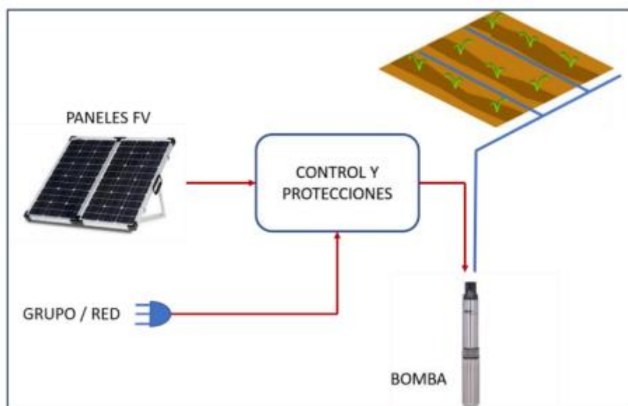
Imagen 22: Funcionamiento del bombeo solar a presión constante [18]
