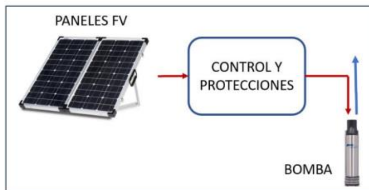
Imagen 19: Funcionamiento del bombeo solar aislado [18]
