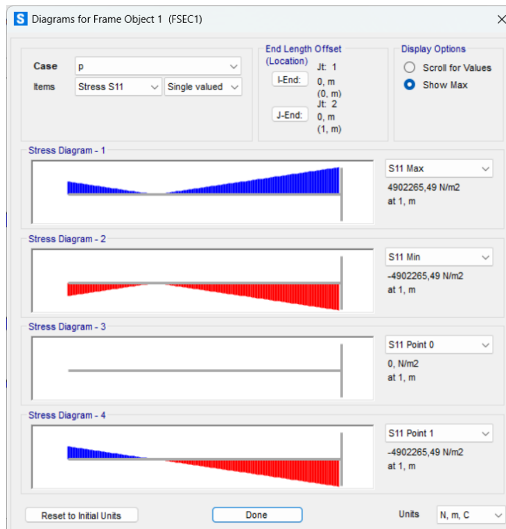
Figura 97: Diagrama de tensiones de la barra aplicando presión Q con la herramienta "Uniform (Shell)"
