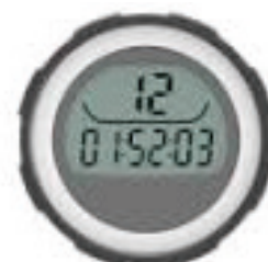
Fig. 66. Pantalla integrada que muestra datos sobre la última dosis. (Novo Nordisk)
