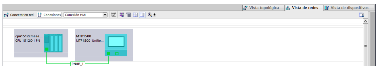
FIGURA 42: REALIZAR CONEXIÓN ENTRE CPU Y HMI (VISTA DE REDES)
