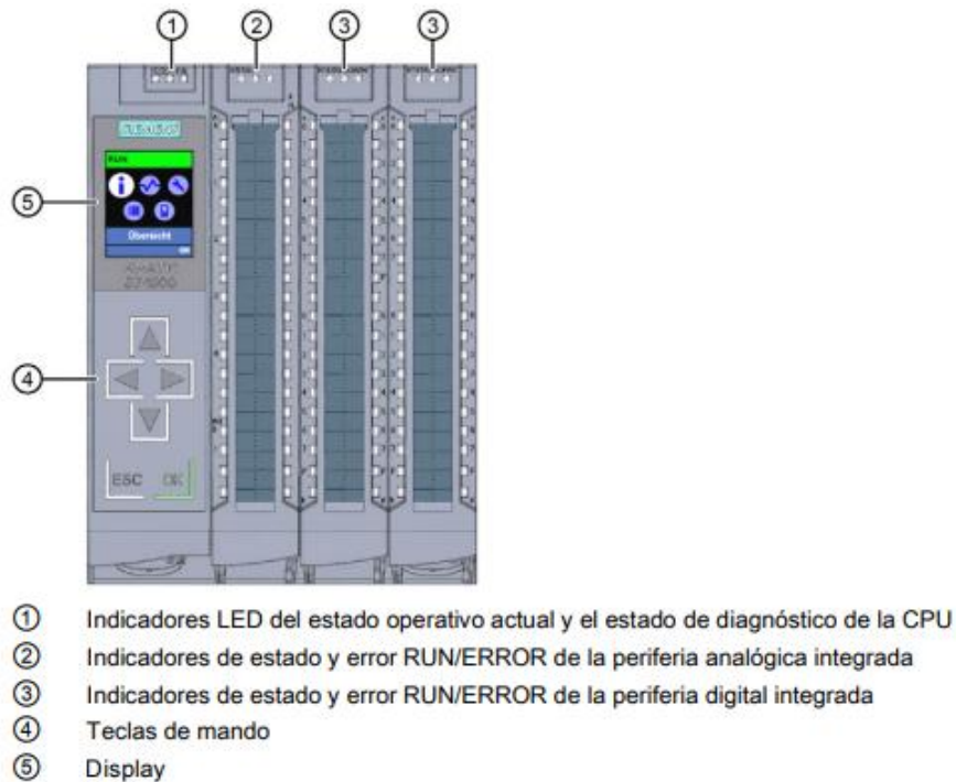
FIGURA 9: VISTA DE LA CPU 1512C-1PN CON LAS TAPAS FRONTALES CERRADAS [5]
