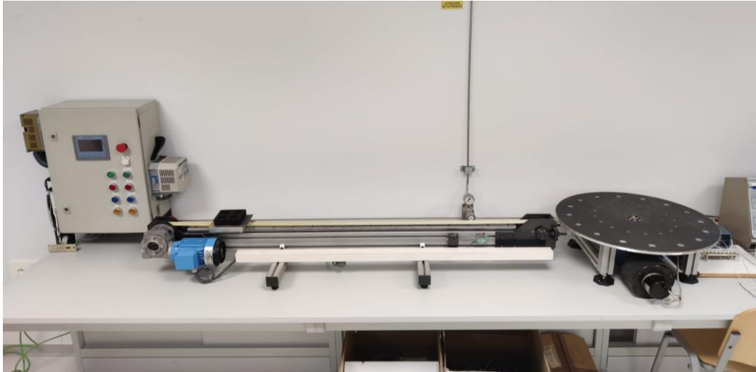
FIGURA 1: SITUACIÓN INICIAL DEL PROYECTO GUÍA LINEAL-MESA CIRCULAR
