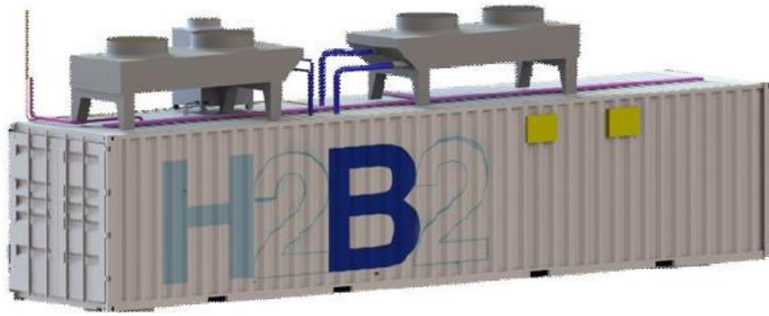
Ilustración 58 - Electrolizador H2B2 EL200N (H2B2) (Mora González, 2021-2022)
