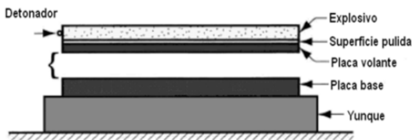
Ilustración 18 – Preparación para proceso de soldadura por explosión. (45)
