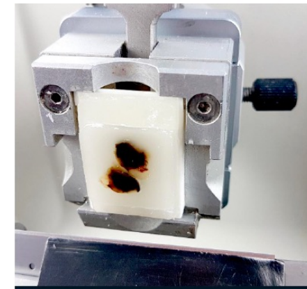
Inclusión de tejido en parafina para cortes en microtomo.
