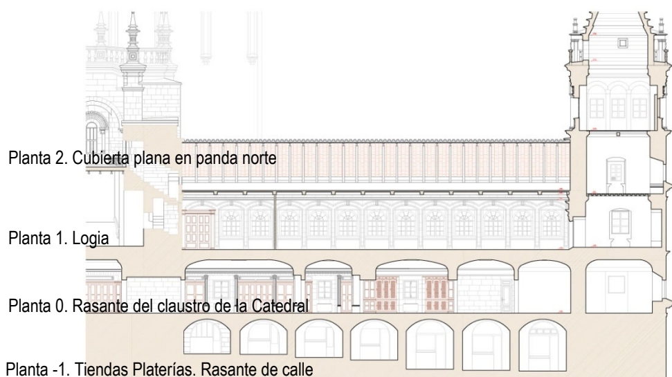
Figura 14: Detalle de sección longitudinal de la Panda Este del Claustro. Corte N-S. Sección hacia oriente. Escalera Oculta por el refuerzo del estribo sur-oeste del crucero románico de la Catedral. Fuente: Dibujos de los autores.
