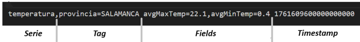
Figura 4.5. Ejemplo LineProtocol para una provincia. Fuente: Elaboración propia
