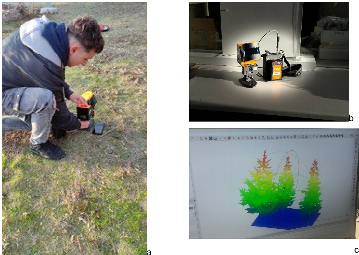
Fig. 3 Proceso de toma de datos con el escáner LiDAR de mano (a), el escáner (b) utiliza el algoritmo SLAM, del inglés Silmultaneus Localization and Mapping (Taheri & Xia, 2021) para, a partir de los rebotes de los pulsos láser, generar la nube de puntos en tres dimensiones (c) que representa la estructura del objeto escaneado, en nuestro caso árboles.
