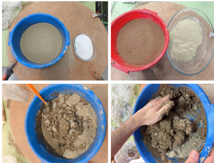
Figura 1. Preparación de las mezclas: izquierda Arcilla greda y mármol, derecha Arcilla roja y serrín. Imágenes de los autores.
