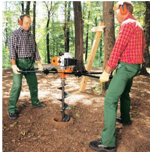
Figura 37. Fotografía de un ahoyador helicoidal trabajando. Fuente: Venta de maquinaria Garrastatxu.
