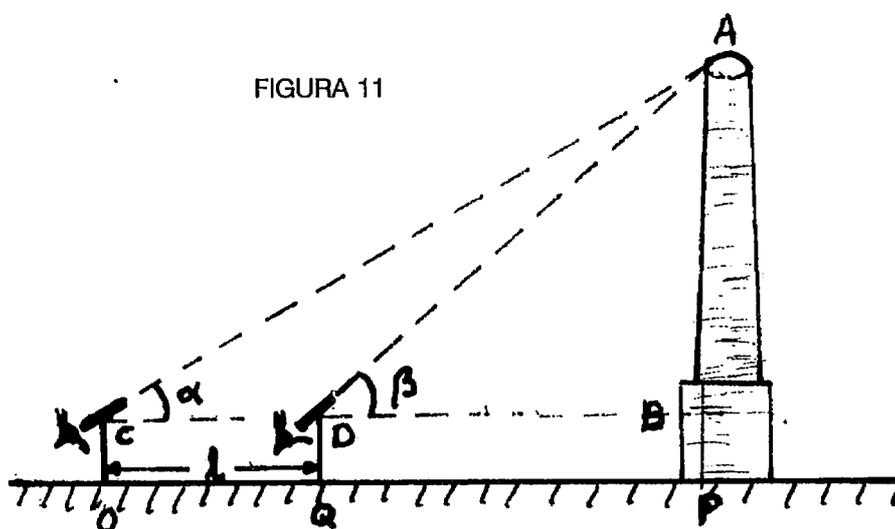
Dibujando en el papel, a la escala que deseemos, el triángulo ADC podemos calcular no sólo la distancia OP sino también la altura de la chimenea, que será  $AP = AB + BP$ .
