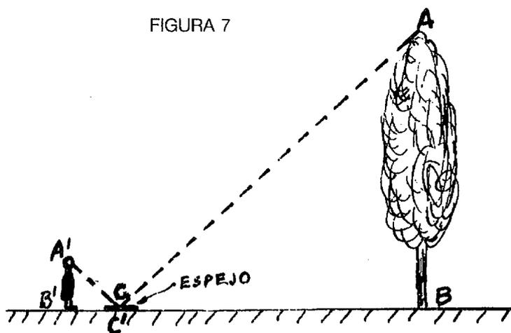
Siendo AB la altura del árbol A'B' la altura desde el suelo a los ojos del alumno, CB la distancia de la base del árbol al punto del espejo en el que se ve el vértice del árbol y C'B' la distancia de este punto hasta donde ha tenido que colocarse el alumno para ver reflejado el vértice.
