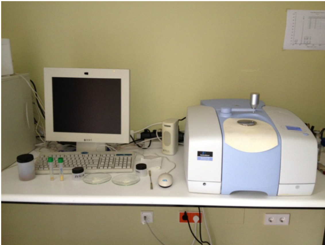
Figura 4.8.- Equipo de FTIR-ATR Perkin Elmer Spectrum 100
