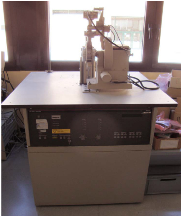
Figura 4.9.- Difractómetro de rayos X Philips PW 1720
