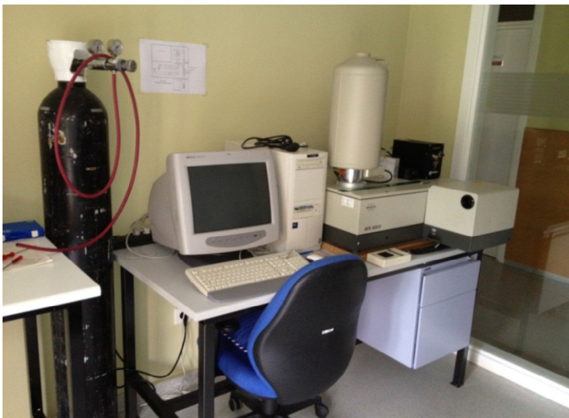
Figura 4.5.- Equipo FT-Raman Bruker RFS100/S.
