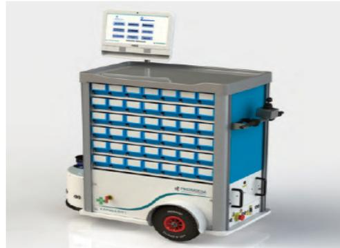
**Figura 6:** Robot móvil para transporte y de dispersión de medicamentos en hospitales.
