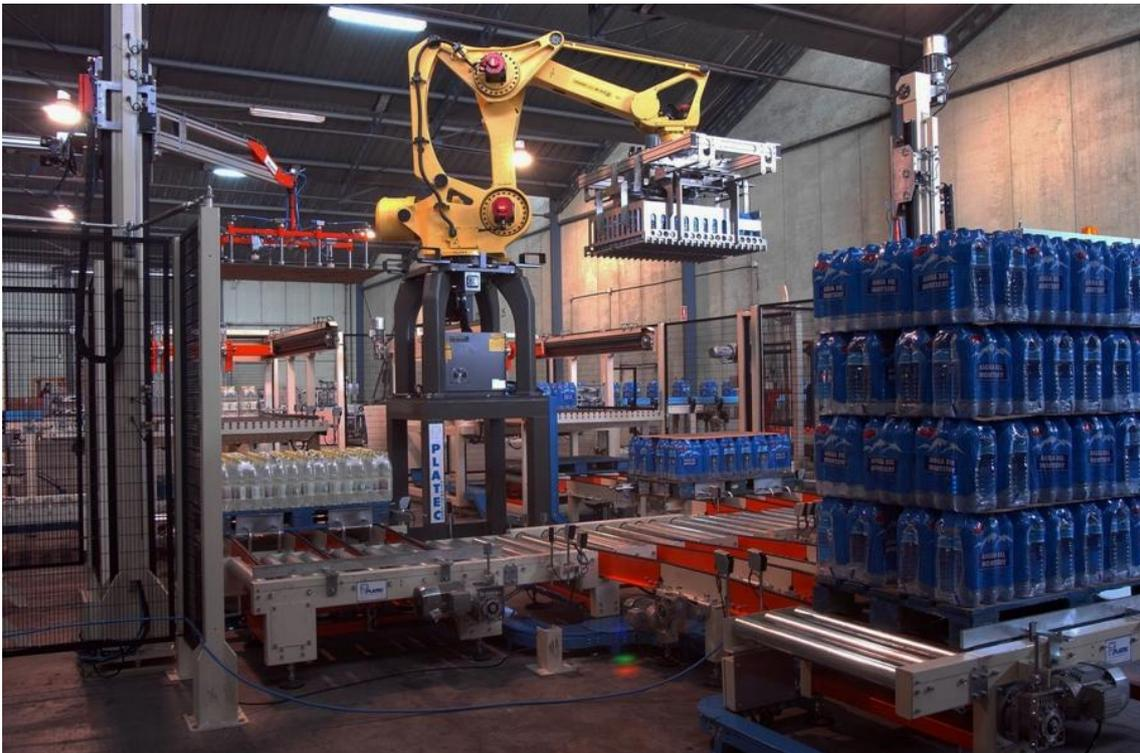
Figura 3: Máquina de paletizado
