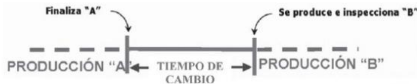
Figura 1.4. Representación del tiempo de cambio de herramienta.
