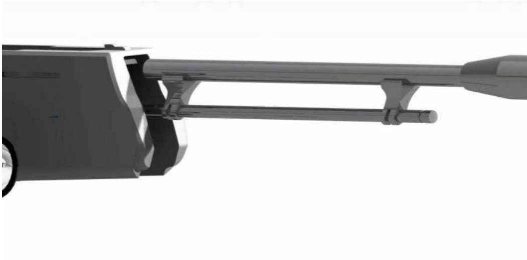
Figura 1.68 - Detalle de cañón de aluminio alojado con sistema magnético
