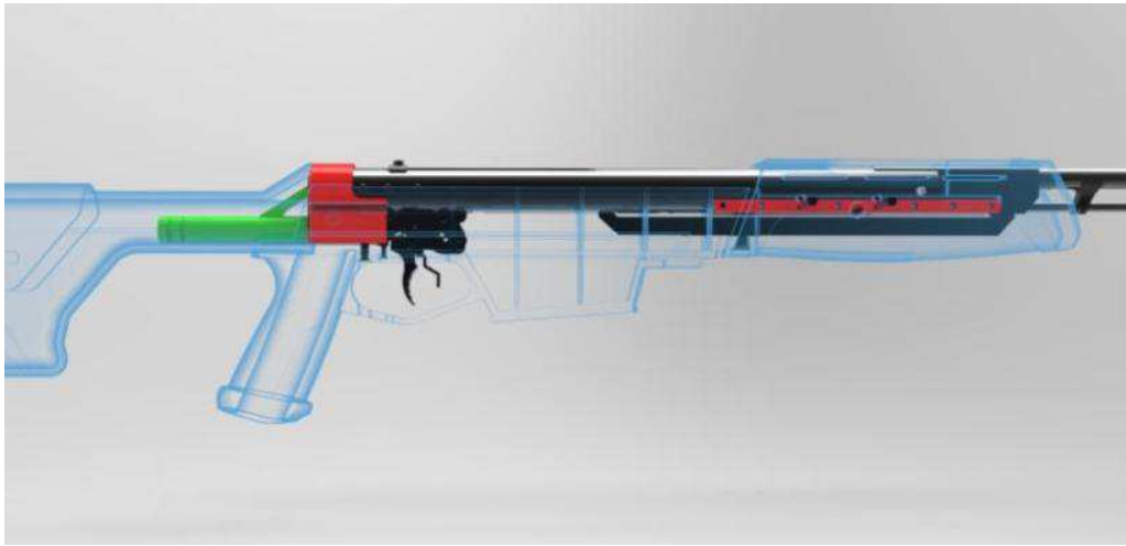
Figura 1.30. Sistema de estructural ideado realizado en dos piezas con sistema de raíles
