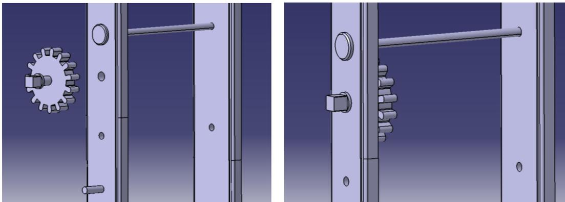
El octavo subconjunto está ligado de nuevo al ensamblaje de la estructura fija. Ambas ruedas dentadas, dispuestas ya concéntricamente, se asocian al eje frontal presente en la pieza de sustento frontal (pieza 44). La unión de revolución se creará en un nuevo mecanismo.
