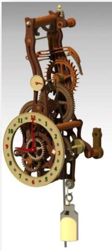
La estructura que sirve de sustento a los distintos elementos que configuran el reloj cuenta con tres puntos de fijación a la pared y sobre estos se cuelga la estructura del reloj.
