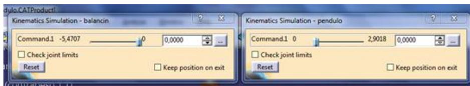
Es necesario relacionar los distintos mecanismos, entre si. Para ello se ha elaborado una tabla en "Excel", con los datos a introducir en las ventanas de animación "kinematics Simulation" para luego ser validados en la ventana de edición de la simulación "edit simulation"
