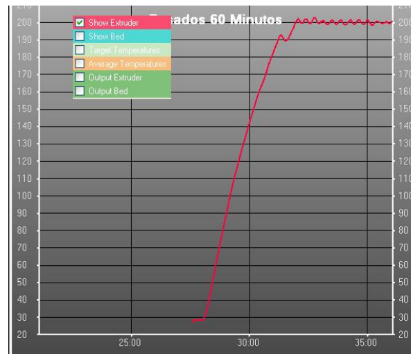
Figura 4.26- Curva de crecimiento de la temperatura en extrusor.
