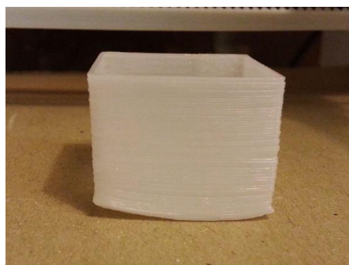
Figura 4.29- Pieza que sufre los efectos de warping
