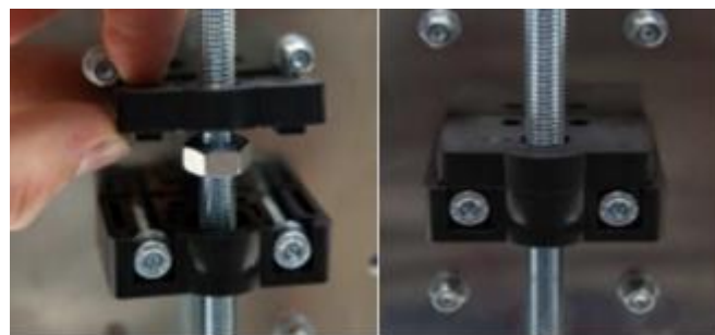
Figura 4.18- conexionado del motor al carrito del perfil izquierdo
