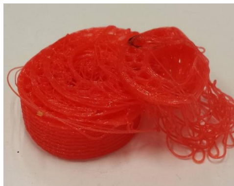
Figura 6.26- Fallo en pieza al moverse durante la impresión.
