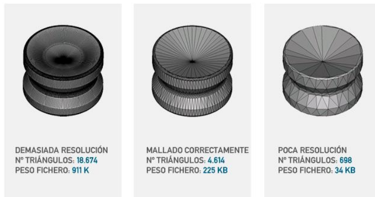
Figura 6.14- Distintas piezas con distintos grados de definición y peso
