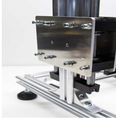
Figura 4.12- Carrito para la construcción del soporte en eje Z
