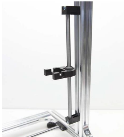
Figura 4.13- Perfil vertical derecho para soporte del brazo del movimiento en Z
