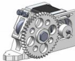
Figura 4.22- Mecanismo de extrusión de material
