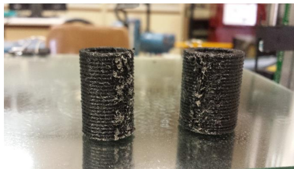
Figura 6.19- Piezas impresas a la vez con rebabas en los puntos de paso.
