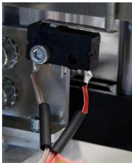
Figura 4.47- Conexionado a patillas del relé.
