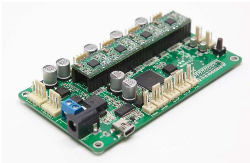
Figura 4.44- Placa de circuito impreso incluido en la impresora para el control
