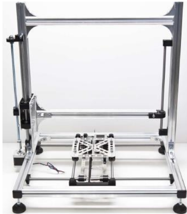
Figura 4.20- Chasis que soportará los elementos de la impresora
