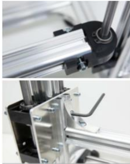
Figura 4.15- Conexiones del soporte a los diferentes perfiles verticales de la impresora
