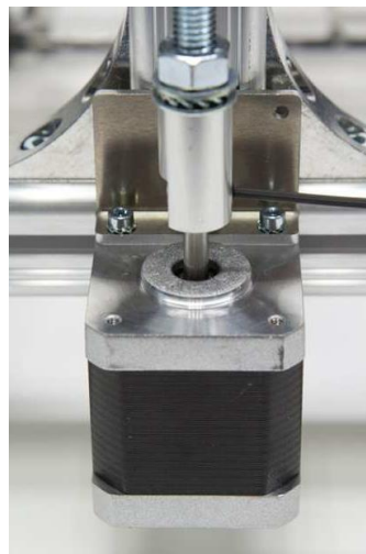
Figura 4.17- Colocación del motor paso a paso que nos dará movimiento a lo largo del eje Z Luego, se conectará mediante un par de adaptadores de plástico, una tuerca y dos tornillos a la placa móvil que sujeta el brazo del extrusor.
