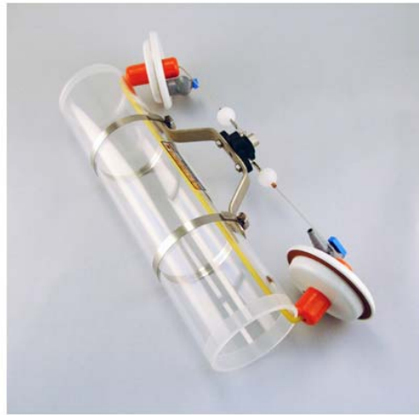
Figura 4.2 Botella de Van Dorn para muestreo de aguas
