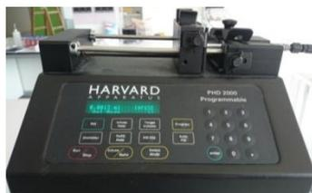
**Figura 5.22** Bomba de flujo para electrohilado PHD 2000.
