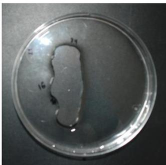
**Figura 5.31** Placa Petri con 4 superficies, recubiertas por fibras, sumergidas en agua a 4°C y almacenadas en un frigorífico.
