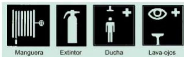
**Figura 8.5** Señalización de los elementos de actuación.
