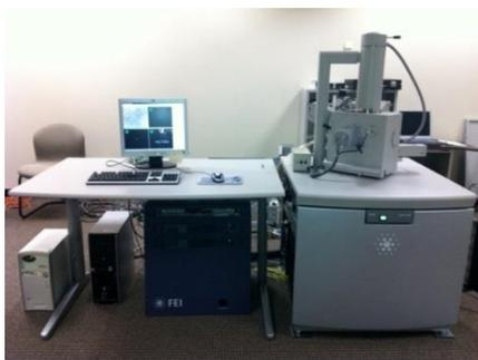
**Figura 5.36** Microscopio Electrónico de Barrido (SEM) de Quanta SEM.
