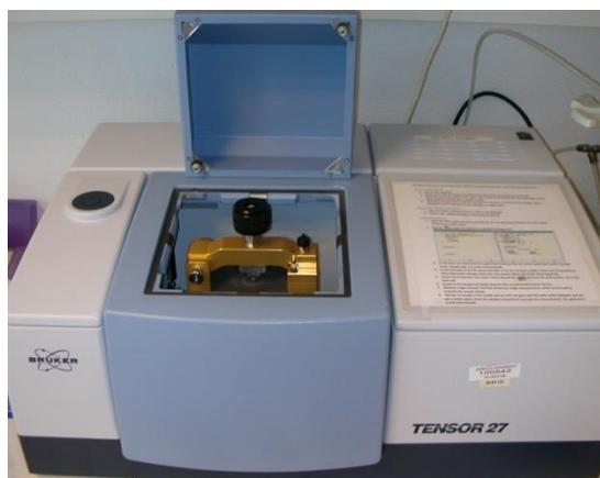
**Figura 5.14** Espectrómetro de infrarrojo Bruker Tensor 27.
