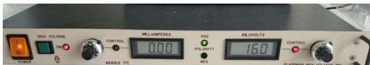
**Figura 5.23** Fuente de alto voltaje para electrohilado de FC Series.
