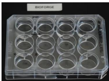
**Figura 5.32** Placa de pocillos con superficies de vidrio recubiertas de fibras en su interior.
