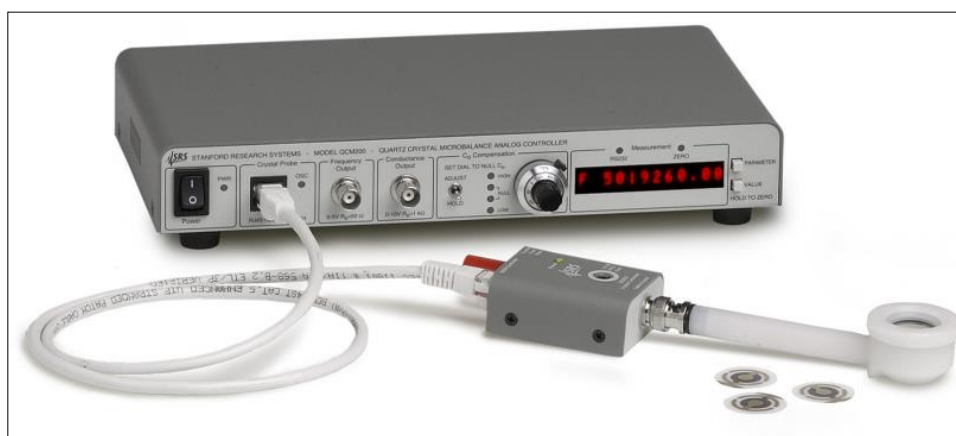
Figura 5. Microbalanza de cristal de cuarzo (Modelo QCM200, Stanford Research Systems).
