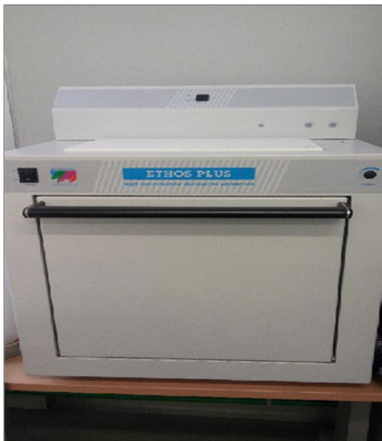
Figura 14.- Horno microondas en el que se realizó la digestión.
