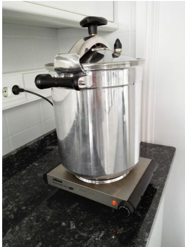
Foto 4.- Proceso de esterilización del material mediante autoclave (olla a presión).
