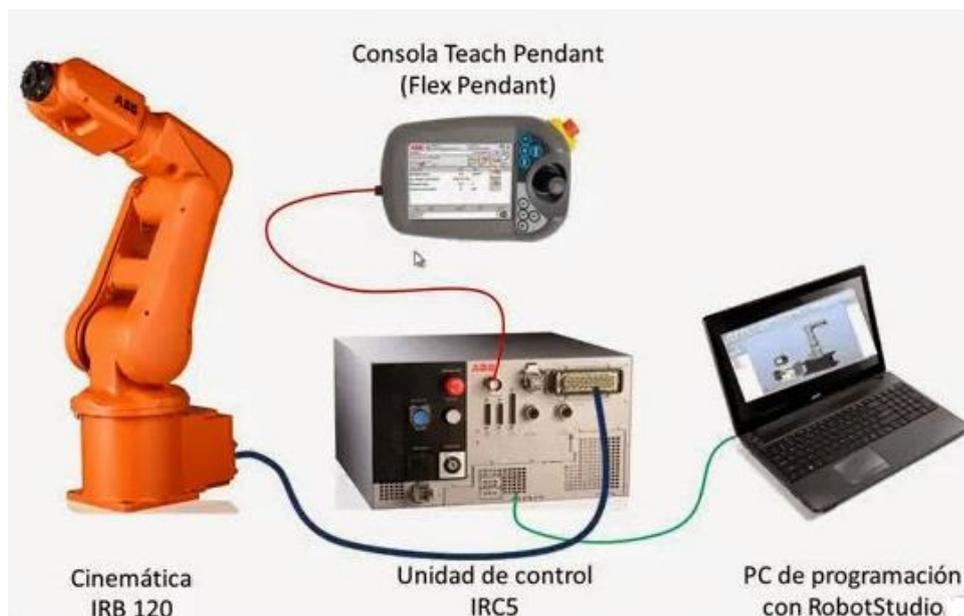
Figura 2.2: Robot IRB-120, Controlador IRC5 y Flex Pendant
