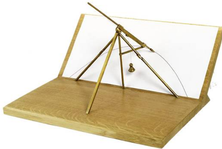
Réplica del parabológrafo diseñado por Leonardo da Vinci. Museo Galileo-Istituto di Storia della Scienza. Firenze, 2001
