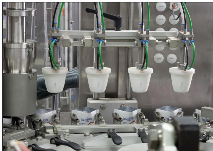
*Sistema de apertura de bolsas mediante pistones con cabeza cónica para la mejor introducción en ellas. También facilitan la salida y que quede totalmente abierta.*
