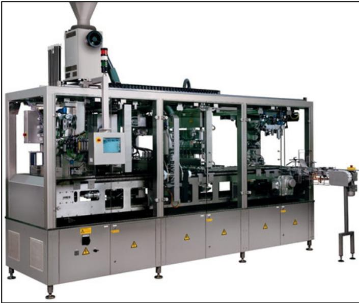
La primera máquina tras la zona del molino se denomina encapsuladora y realiza la tarea de llenado de la cápsula y posterior termosellado de la misma. Las cápsulas se han de alimentar de manera manual en tandas de 50 en 50 introduciéndolas en unos carriles de guiado. La máquina va llenando cada cápsula con el producto que bien de las tolvas del molino y a partir de una bobina aluminio, cierra herméticamente por termosellado cada una de ellas.
