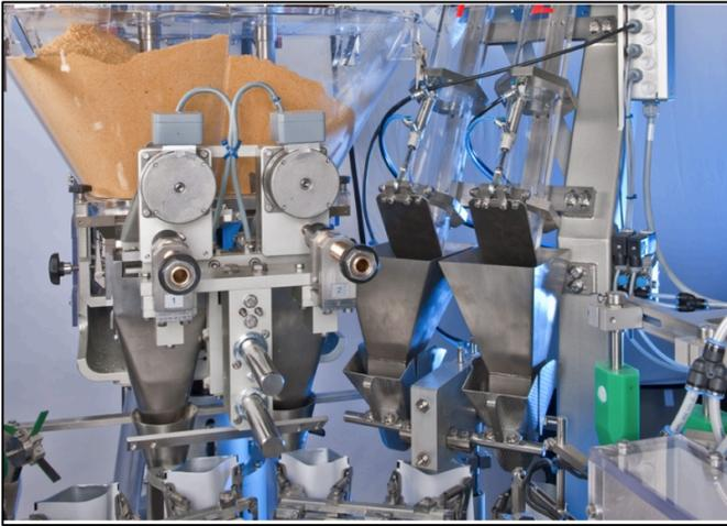
*Mecanismo de dosificación de polvo de café a la máquina de encapsulado.*
