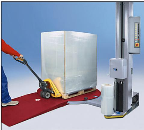
*Tarea de transporte sobre traspaleta del palet para retractilarlo en la máquina de retractilado semiautomático*
