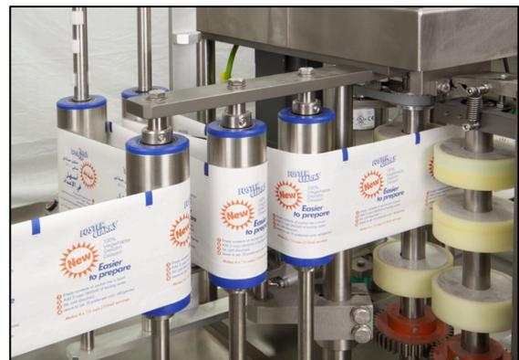
*Paso del papel de la bolsa procedente de la bobina, a través de rodillos que le dan forma para obtener la geometría final*
