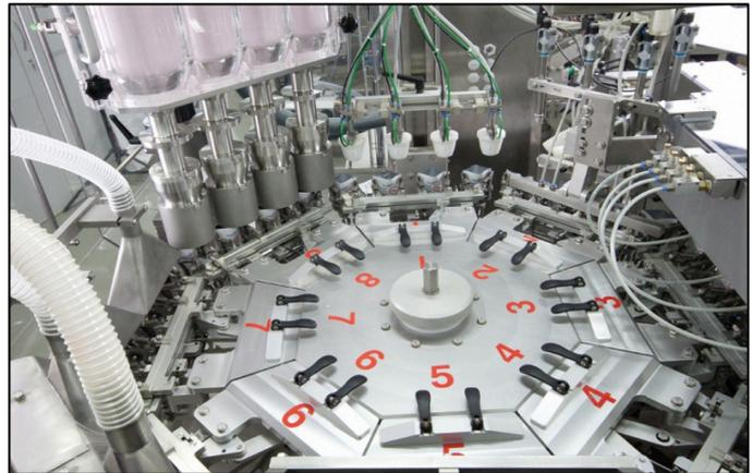
*Tolva dinámica dosificadora de cápsulas por peso y vibración. A su derecha la zona donde se abre la bolsa para que dentro caigan las cápsulas. El llenado se realiza mientras la bandeja con las bolsas va girando, así entran vacías por una posición adyacente a por donde salen. La cadencia de bolsas por vuelta completa es función del número de soportes para bolsitas que tiene esta bandeja.*
