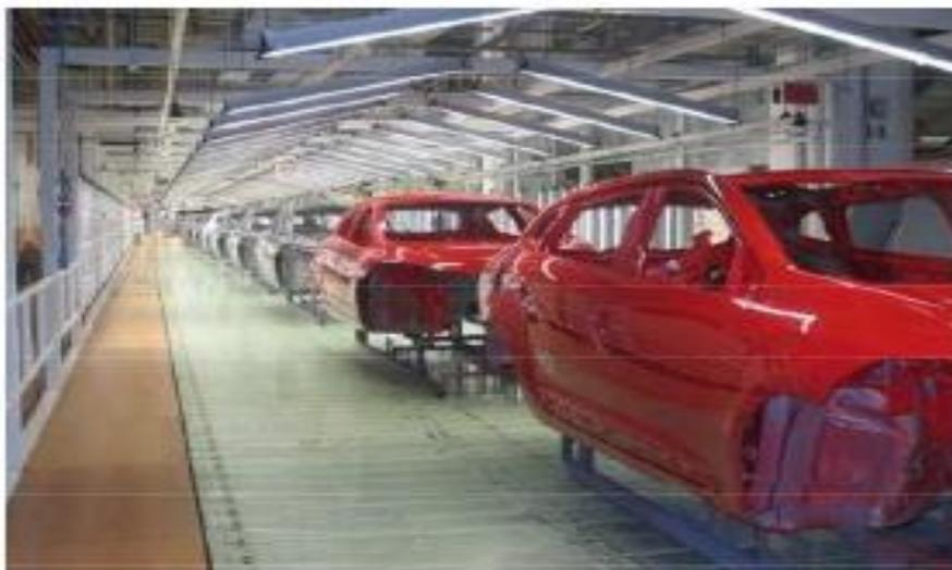
ILUSTRACIÓN II-9. LÍNEA DE TERMINACIÓN BASES AGUA.
