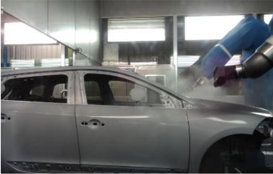
ILUSTRACIÓN II-7. PROCESO APLICACIÓN BASES AGUA.
