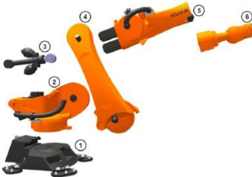
ILUSTRACIÓN IV-32. COMPONENTES MECÁNICOS DEL ROBOT.
