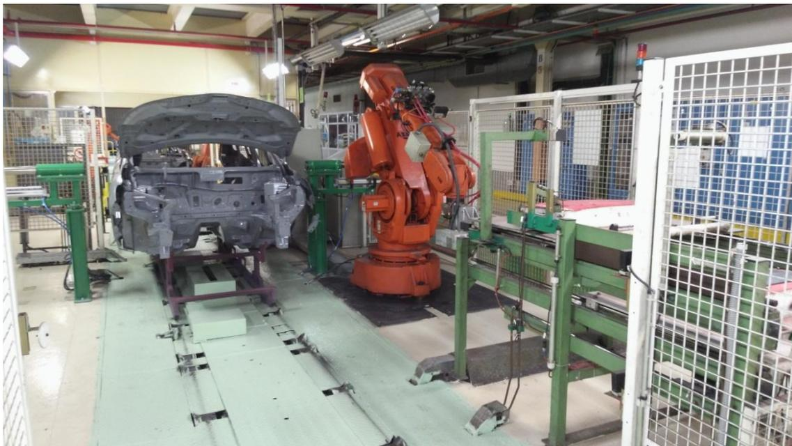
ILUSTRACIÓN V-7. ROBOT TECHO 2
