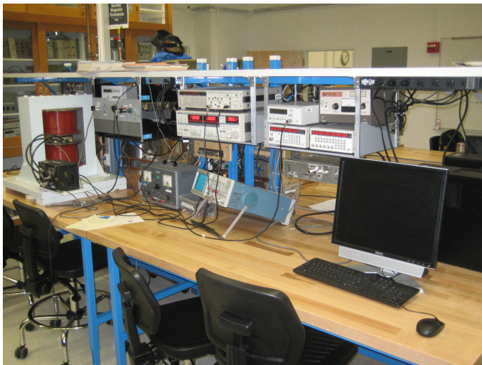
Figura 2.13: Montaje de un espectrómetro de resonancia magnética nuclear (NMR) en el Laboratorio de Experimentación Avanzada Donald A. Glaser de la Universidad de California, Berkeley, Estados Unidos. Fotografía de Donald J. Tomado de [30].
