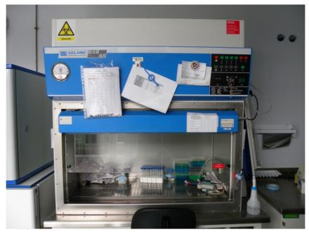
Figura 3: Cabina de flujo laminar Gelaire BSB 4A.
