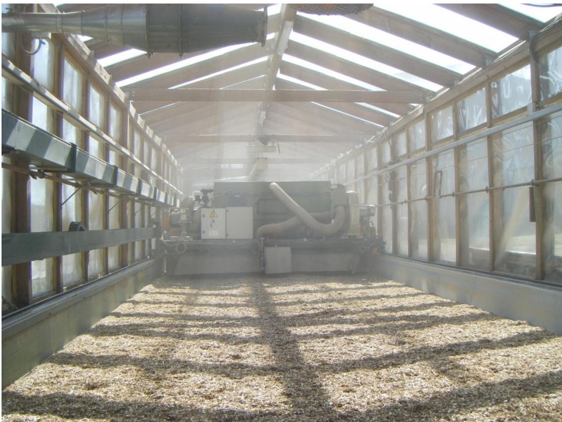
**Figura 18.** Detalle de la planta de secado solar durante el secado de la muestra *Astilla de olmo 2*. Fuente: elaboración propia
