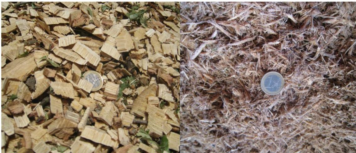
**Figura 10.** Detalle de astillas de la muestra *Roble verde astillado* (izquierda) y de *Roble verde triturado* (derecha). Fuente: Elaboración propia
