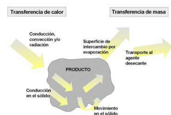
**Figura 6.** Transferencia de masa y energía en el secado térmico. Fuente: (Montero, 2005)
