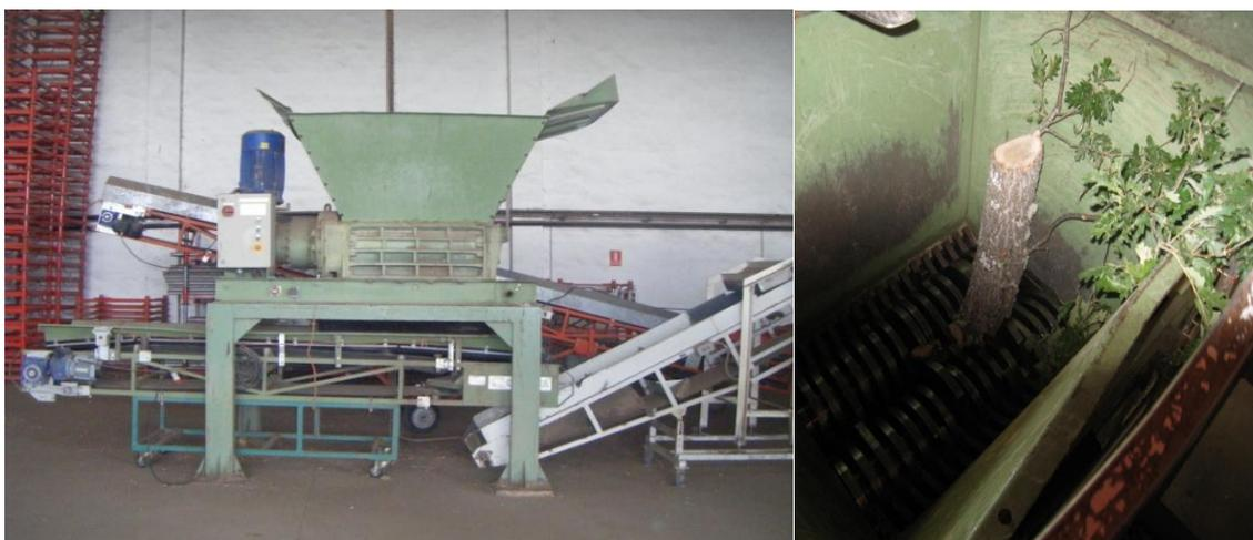
**Figura 12.** Izquierda: Tritrador de giro lento de doble eje. Derecha: Detalle del proceso de trituración en la muestra *Roble verde triturado*. Fuente: Elaboración propia
