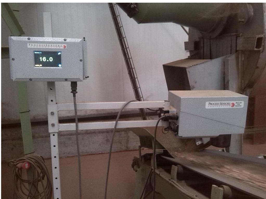
**Figura 25.** Detalle del NIR funcionando a la salida del material del secadero rotativo. Fuente: Elaboración propia
