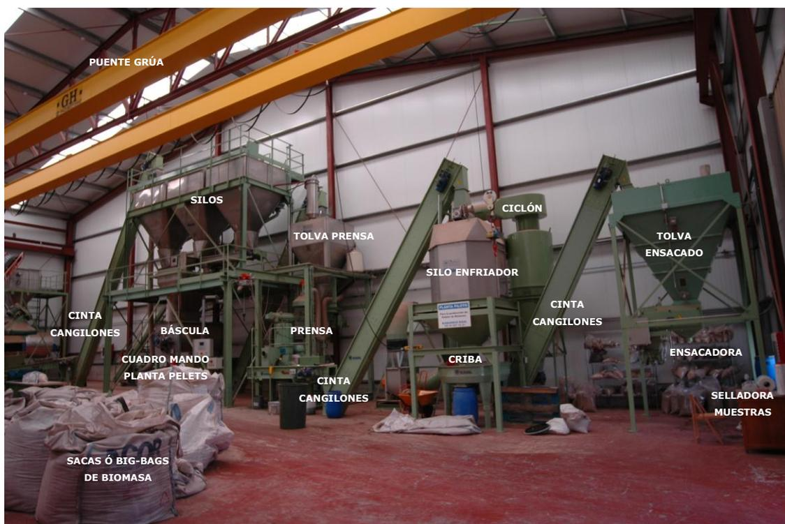
**Figura 22.** Vista de la planta piloto de peletizado con indicación del equipamiento
