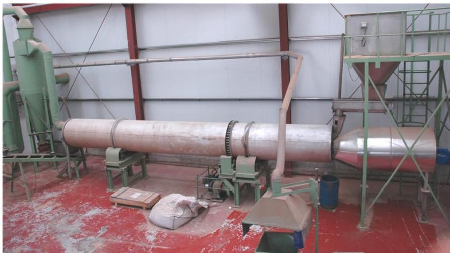
**Figura 15.** Vista del secadero piloto tipo trómel. Fuente: Elaboración propia
