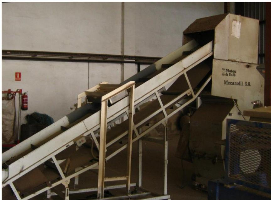
Figura 13. Molino de cuchillas y cinta transportadora. Fuente: Elaboración propia
