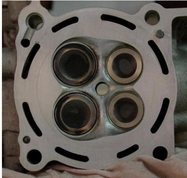
*Figura 3: vista de la culata con las cuatro válvulas montadas y sin bujía.*
