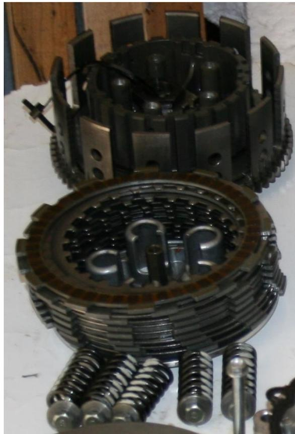
*Figura 4: vista del embrague multidisco desmontado.*
