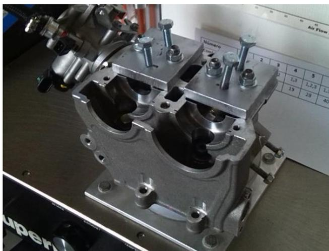
Figura 24: imagen de la culata montada en el banco de flujo.
