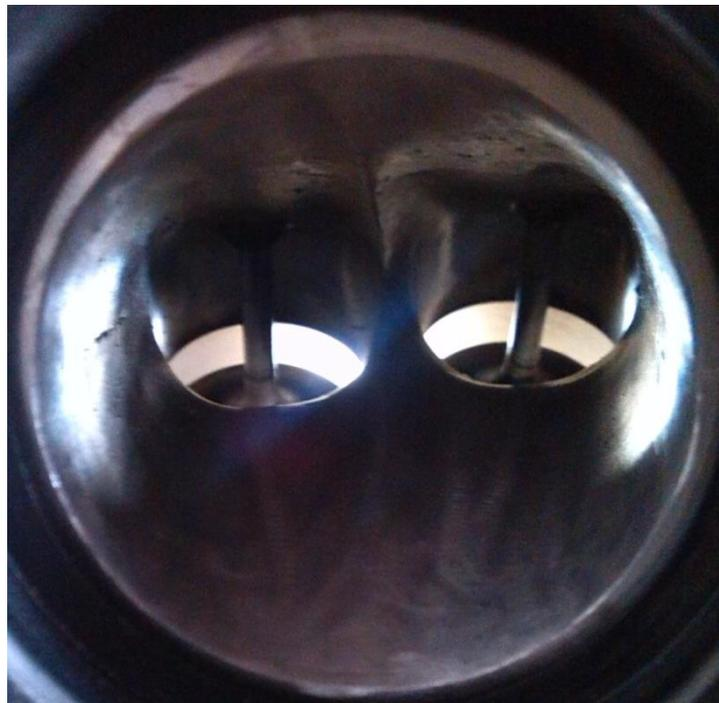
Figura 32: imagen del conducto de admisión con las mejoras realizadas.
