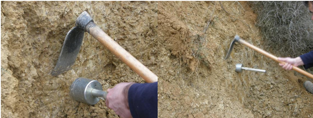
Figura 6.3. Introducción del cilindro en el terreno (izda). Extracción del cilindro con muestra (dcha).
