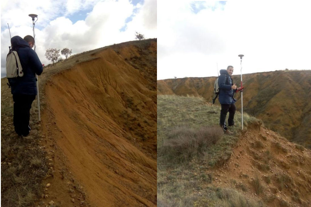
Figura 6.5. Toma de puntos mediante GPS, en la divisoria de escorrentía directa.
