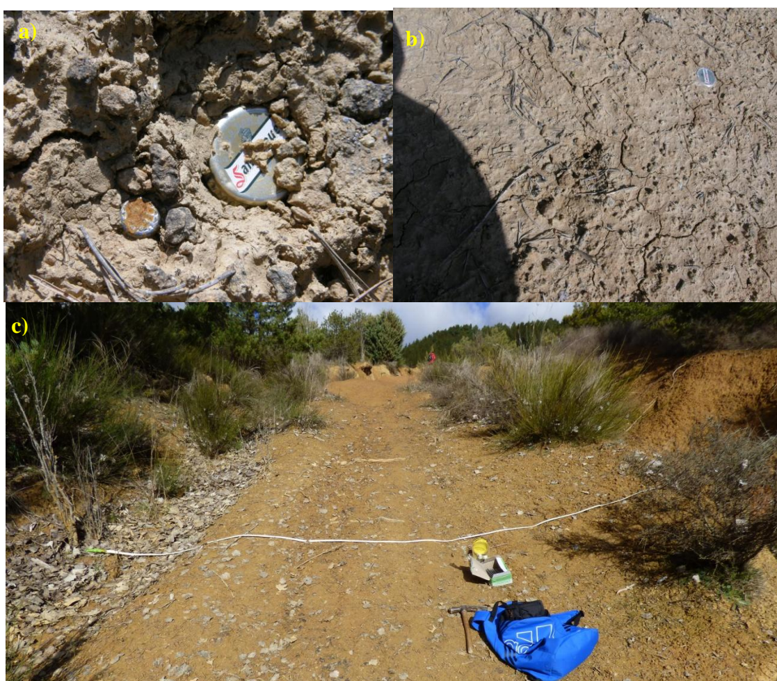
Figura 6.6. Secciones transversales de clavos y chapas para medir erosión situadas en cárcavas asociadas a una pista forestal. a) clavos y chapas introducidas en el suelo. b) Chapa enrasada con el suelo. c) Vista de una sección completa.
