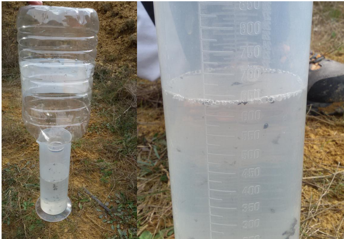
Figura 6.15. Vaciado del depósito en recipiente de medida (izda). Medición de la cantidad de agua recogida (dcha).
