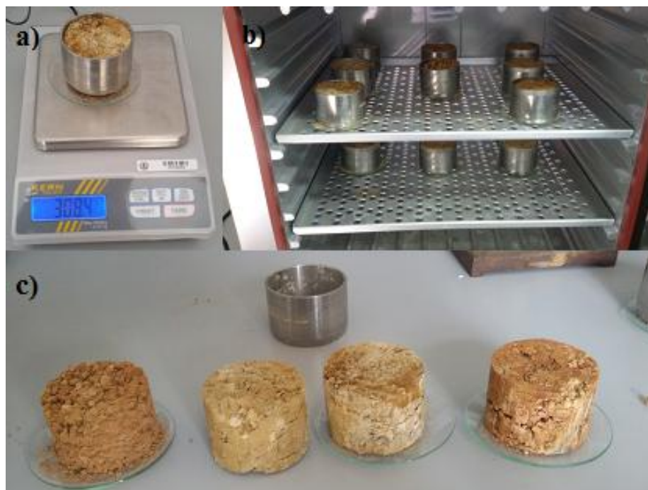
Figura 6.4. Procedimiento de laboratorio para la determinación de la densidad aparente. a) Pesado de muestras en balanza; b) Secado de las muestras en estufa; c) Muestras inalteradas tras todo el proceso.
