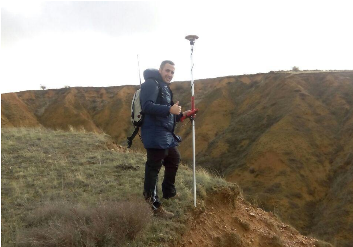
Figura 11.12. Uso del GPS centimétrico para delimitar la divisoria de escorrentía directa.
