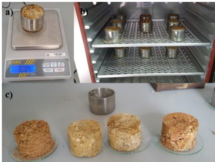
Figura 11.7. Procedimiento de laboratorio para la determinación de la densidad aparente. a) Pesado de muestras en balanza; b) Secado de las muestras en estufa; c) Muestras inalteradas tras todo el proceso.
