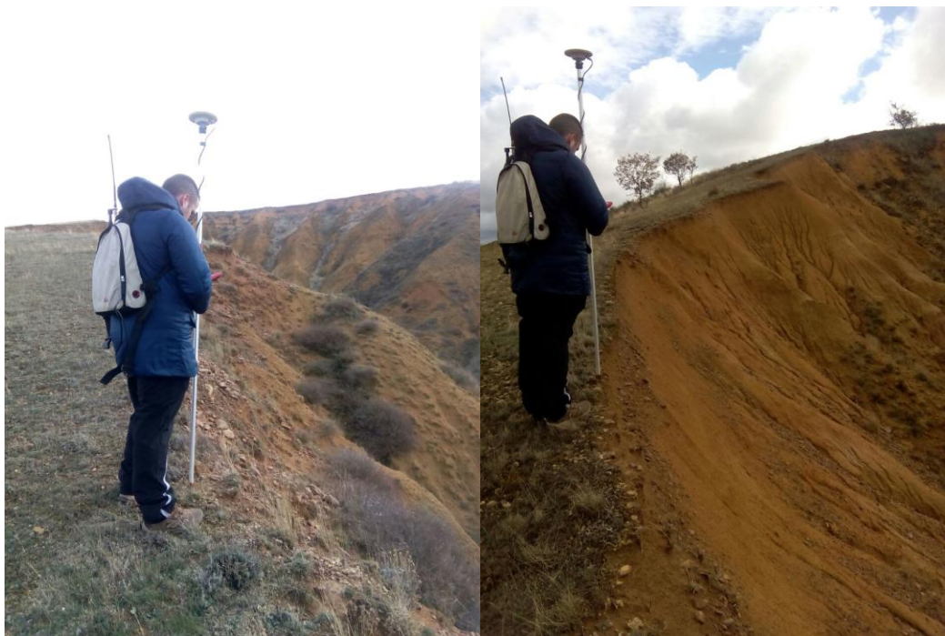
Figura 11.24. Toma de puntos mediante GPS, en la divisoria de escorrentía directa.
