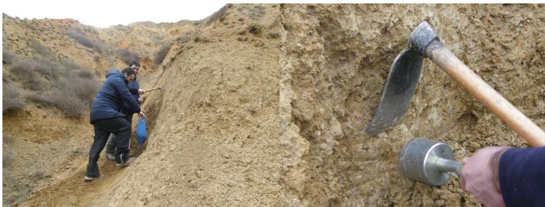
Figura 6.1. Toma de muestra alterada (izda) e inalterada mediante cilindro de muestreo (dcha).
