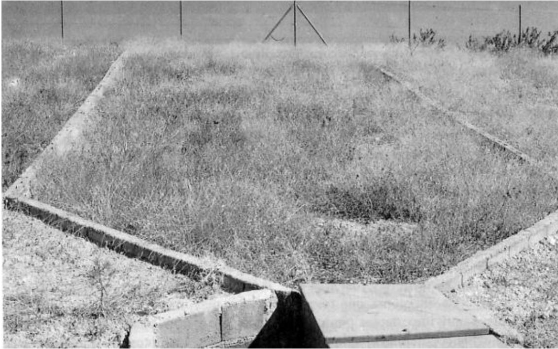
Figura 3.5. Parcela experimental cerrada construida por el Centro de Edafología y Biología Aplicada del Segura (CEBAS) (López Bermúdez et al. , 1993).
