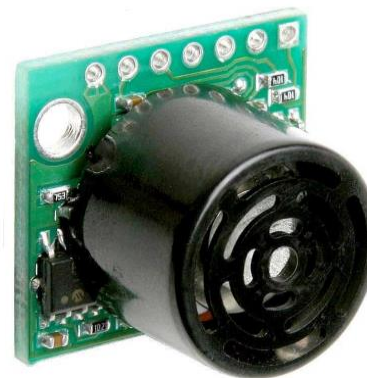
Figura 45: Sensor de ultrasonidos. Vista anterior
