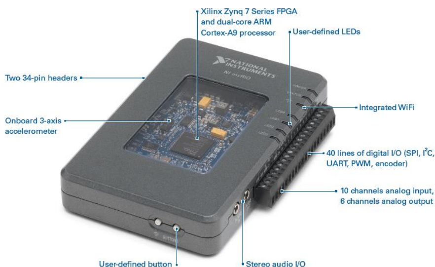
Figura 30: Dispositivo comercial MyRIO de National Instruments
