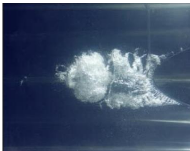
Figura 6: Burbujas por cavitación
