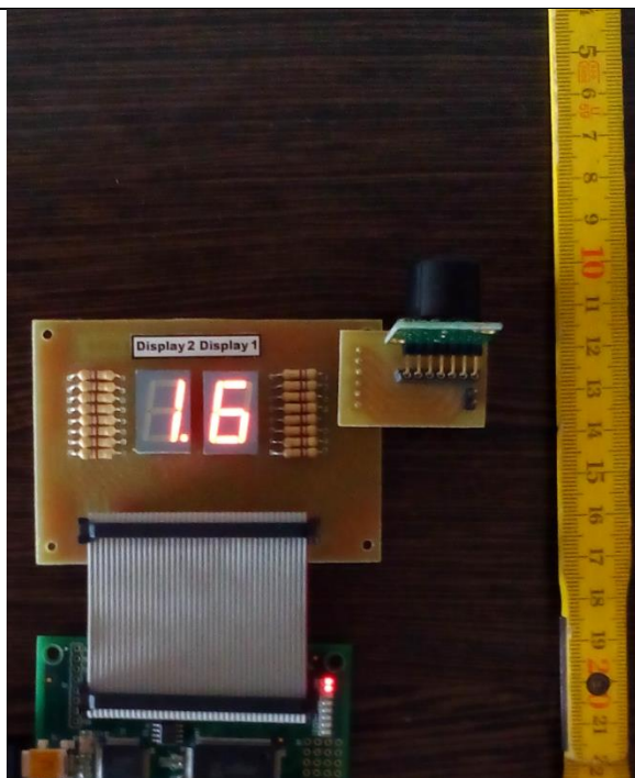
Figura 132. Medición de la distancia mínima
