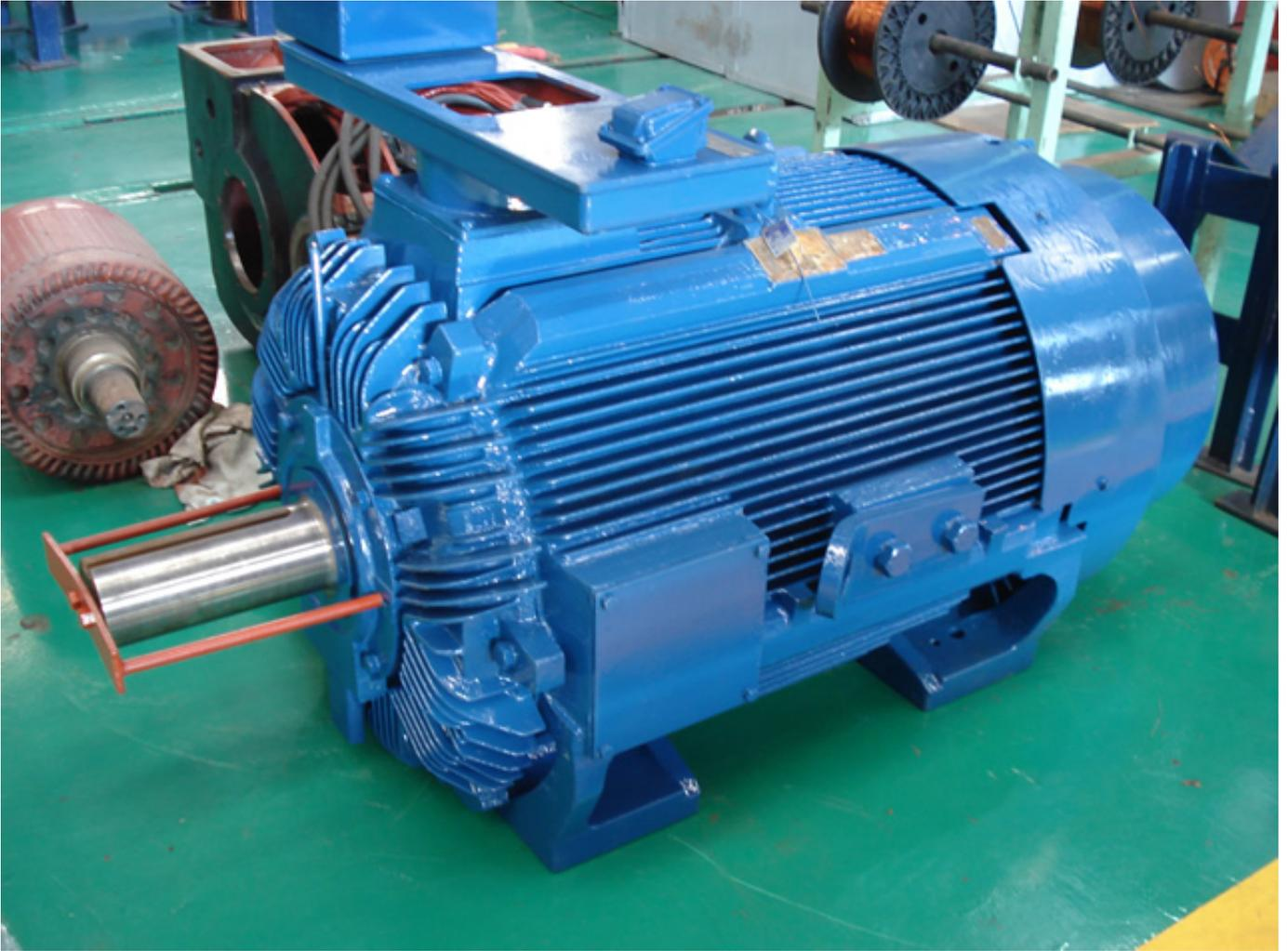
FIGURA 3.3: Motor eléctrico real de 250 HP
