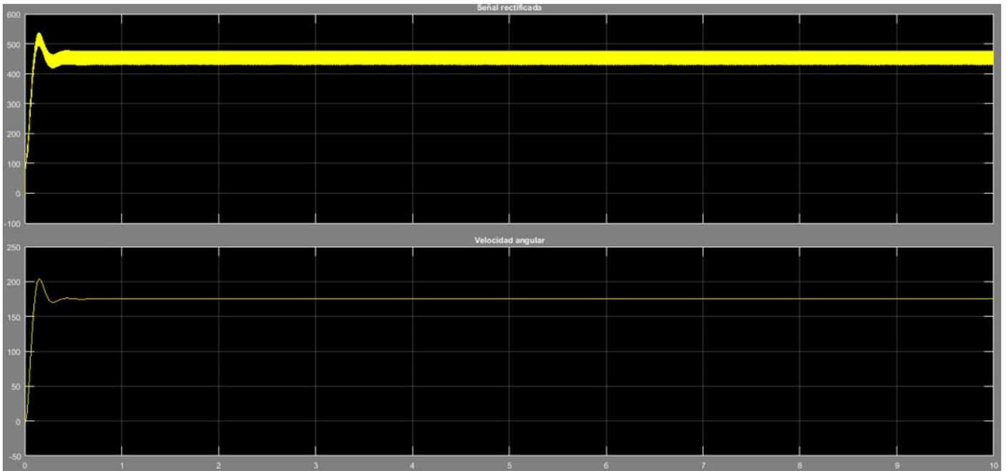
FIGURA 7.17: Resultados de velocidad angular y tensión de entrada para  $\alpha = 30$
