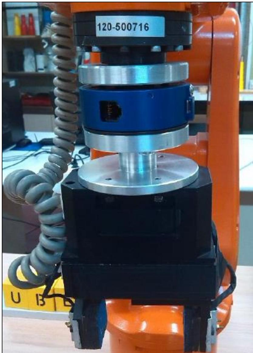
*Figura 2.3: Herramienta de trabajo (Pinza de agarre)*
