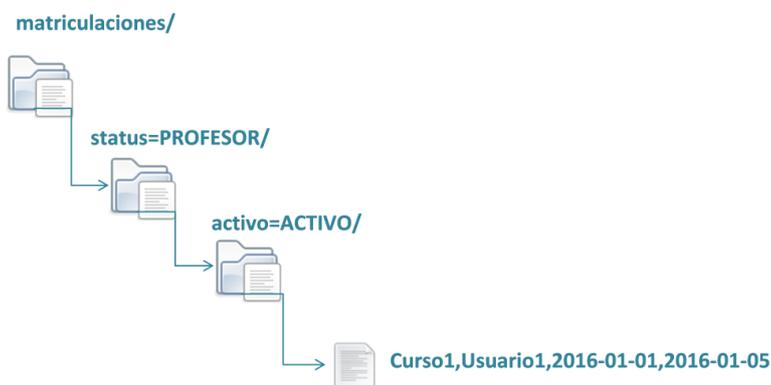
Figura 94. Ejemplo de estructuración de datos con particionado de tablas en *Hive III*
