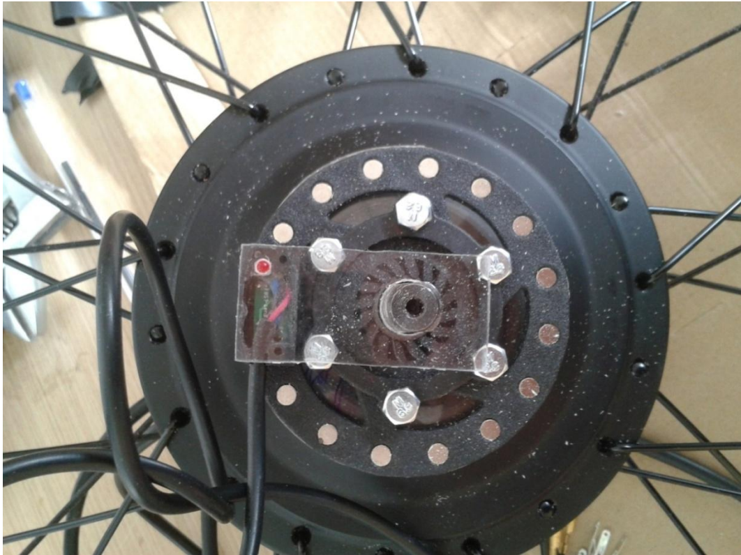
Imagen 11.4.8:1 - Montaje de los sensores Hall en el eje de las ruedas
