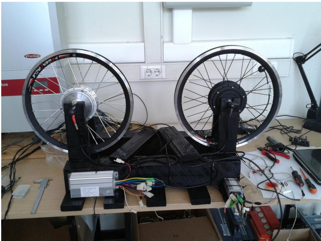
Imagen 11.4.8:6 - Estructura final con el montaje de los componentes
