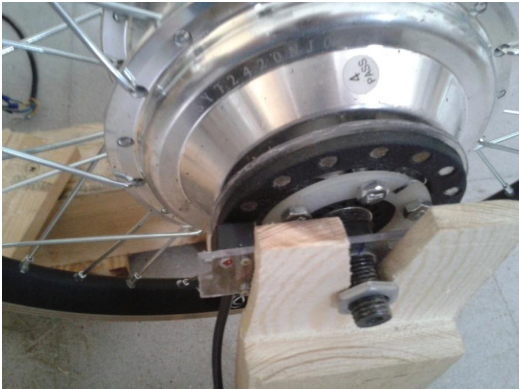
Imagen 11.4.8:2 - Visualización del montaje de las ruedas en el soporte
