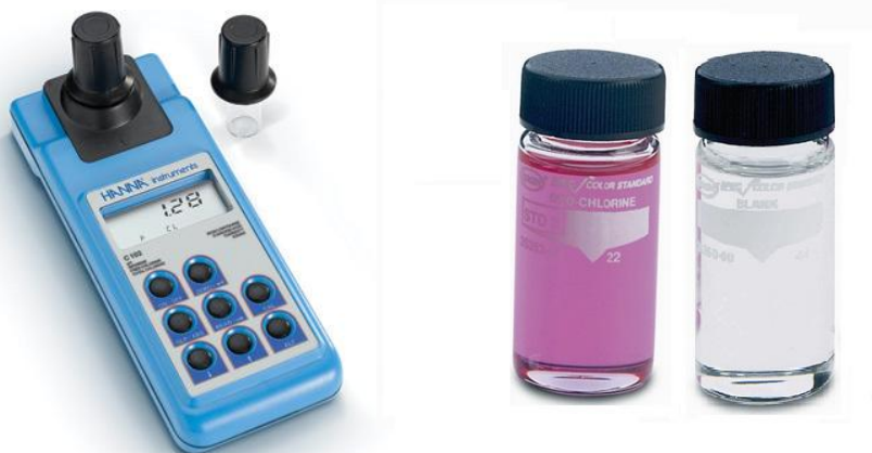
Figura 22. Kit para medir la concentración de Cloro libre residual presente en el agua potable
