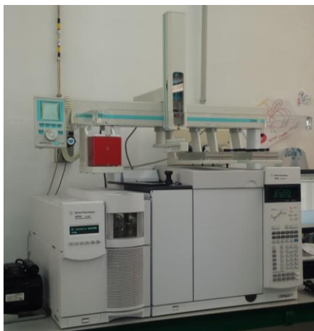
FIGURA 11: Cromatógrafo de gases GC7890A acoplado a un espectrómetro de masas MSD 5975C con un detector de masas.
