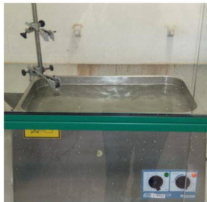
FIGURA 9: Vial con 4 gramos de una muestra en el baño de agua con aplicación de ultrasonidos.
