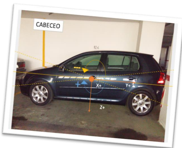
Ilustración 15 CABECEO. SE PRODUCE ALREDEDOR DEL EJE X
