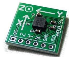
Ilustración 1 ACELEROMETRO SOBRE CHIP DE SILICIO: (DESCONOCIDO, Blog WEB: BLOGGER, 2012)
