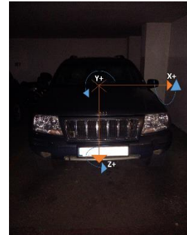
Ilustración 20 SISTEMA DE REFERENCIA VEHICULO TT
