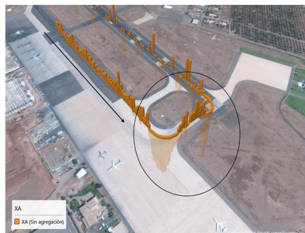
Ilustración 59 ACCELERACION EN X. PISTA DE CARRETEO AEROPUERTO MENARA, MARRAKECH
