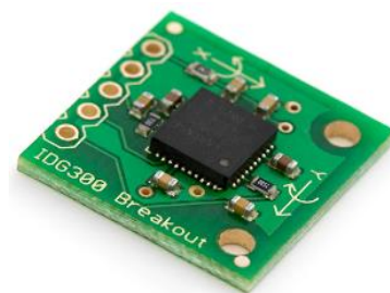
Ilustración 5 GIROSCOPIO SOBRE CHIP DE SILICIO. Foto: (DESCONOCIDO, Blog WEB: BLOGGER, 2012)
