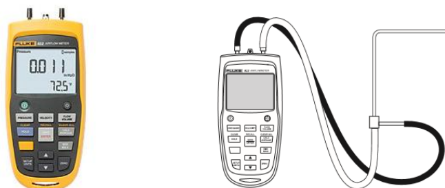
Figura 39. Equipo utilizado para la medida de caudales de aire
