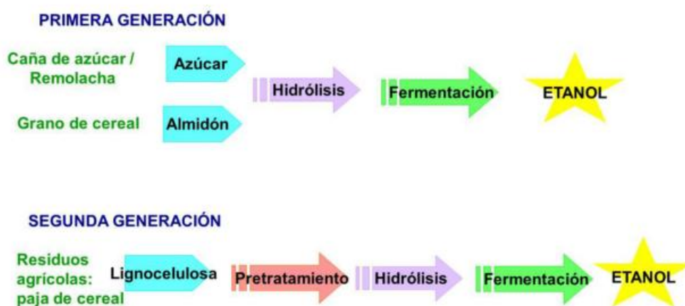
Figura 1.2: Esquema de producción de etanol de 1G y 2G a partir de las diferentes materias primas (García and Martínez, 2012)
