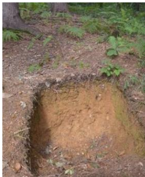
Figura 11. Calicata en suelo Cambisol dístrico, propio de la zona de Rožnik, donde se sitúa la parcela de bosque mixto. Fuente: (Emonfur, 2015).
