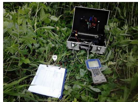
Figura 20. Instalación y medición de la humedad del suelo con el equipo TDR.
