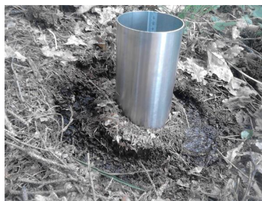
Figura 17. Instalación del cilindro en pendiente. Siempre perpendicular a la horizontal y no al terreno.
