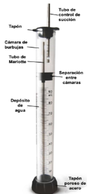
Figura 3. Infiltrómetro de minidisco con las partes que lo componen. Extraído de Decagon (2014).
