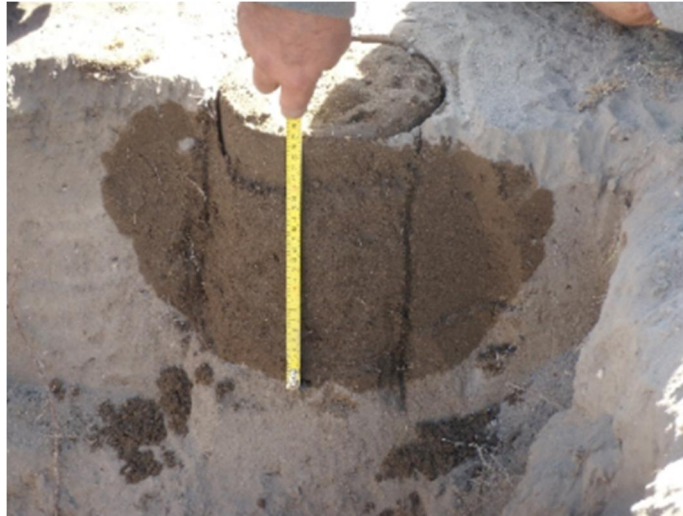
Figura 2. Bulbo de humedad tras una hora de ensayo con un infiltrómetro de anillo simple. El flujo lateral es evidente. Extraído de Godagnone et al. (2012).
