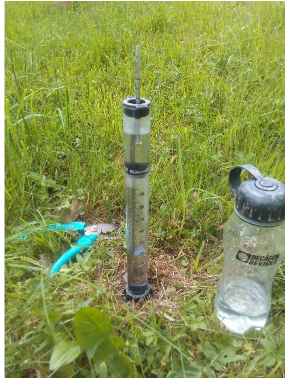
Figura 19. Detalle de montaje del infiltrómetro de minidisco en la pradera de Rožnik.
