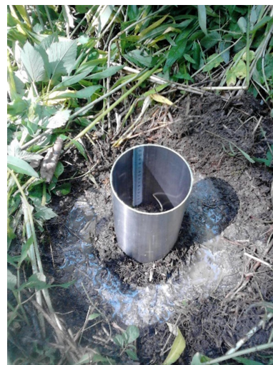
Figura 16. Instalación del infiltrómetro de anillo simple y detalle de la escala de medida.
