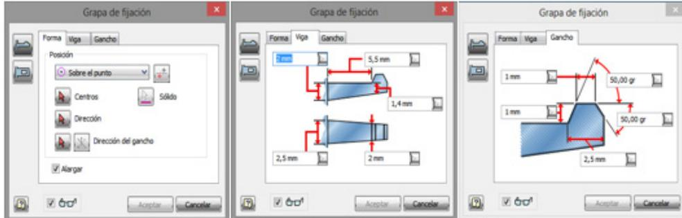
Figura 4.56 Creación de una pestaña plástica
