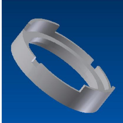
Figura 4.55 Rebajes carcasa del piñón
