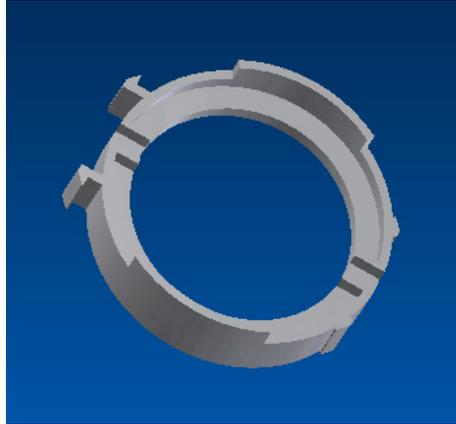
Figura 4.57 Resultado final Carcasa del piñón
