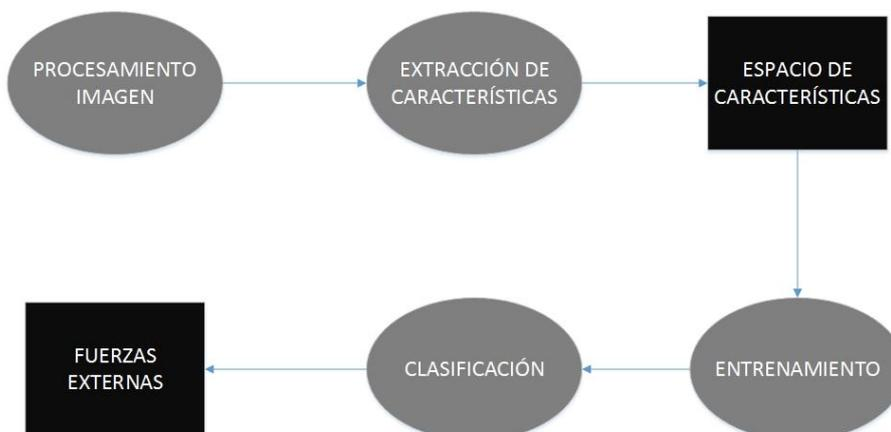
**Figura 3.2.** Diagrama de bloques del algoritmo para el cálculo de las fuerzas externas.
