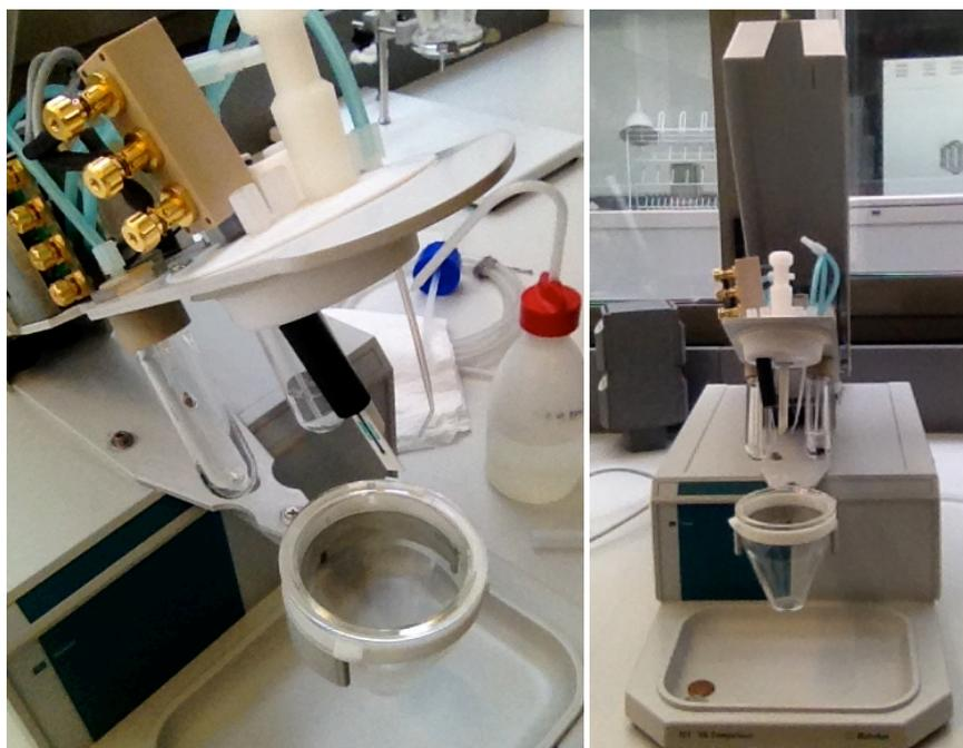
**Fig. 3.1.2.1** Celda electroquímica y equipo ASV utilizado
